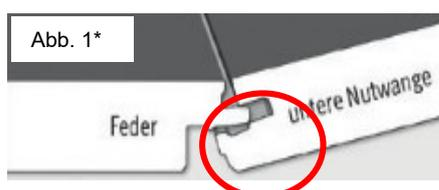
Für die erste Reihe werden die Nutwangenseiten der Platten so abgeschnitten, dass die untere Nutwange, die über die Deckfläche hinausragt, wegfällt (Abb.1\*).
